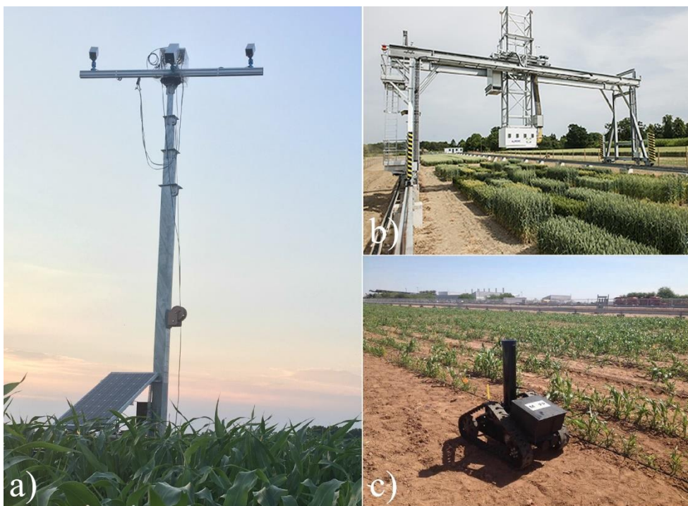
Slika 2. Sistemi za visokopropusnu fenotipizaciju na tlu. a) stacionarni toranj (Shafiekhani i sar., 2017), b) platforma za skeniranje useva (Virlet i sar., 2017), c) autonomni sistem za prikupljanje podataka (Young, i sar., 2019)
