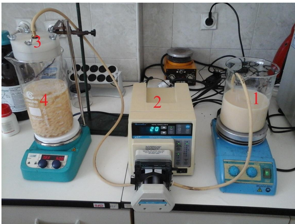
Slika 4. Sistem za inkapsulaciju: 1) suspenzija ćelija u nosaču; 2) peristaltička pumpa; 3) dizna za inkapsulaciju; 4) rastvor za geliranje (foto S. Lević).
