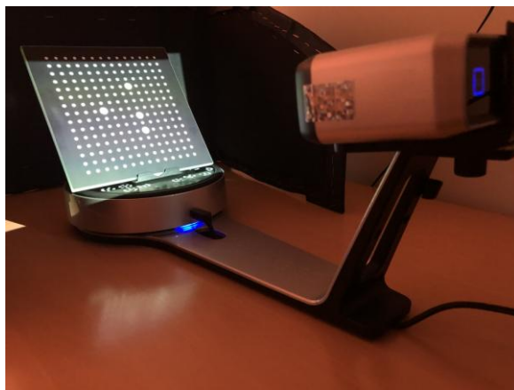
Slika 15. Kalibracija Shining 3D EinScan-SP 3D uređaja (Shining 3D, Hangzhou, Kina) pomoću kalibracione table
