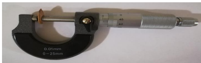
Slika 1. Određivanje debljine semena šljive manuelnim mikrometrom
