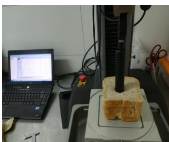
Slika 10. Analizator teksture TA1
