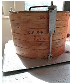
Slika 3. Tresilica sa setom sita za određivanje frakcija pogača posle mlevenja
