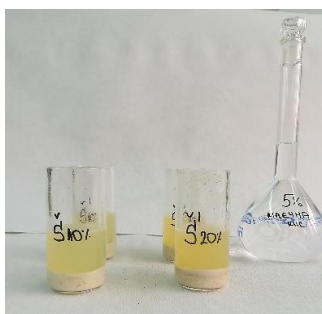
Slika 9. Određivanje sposobnosti zadržavanja rastvarača (mlečna kiselina)
