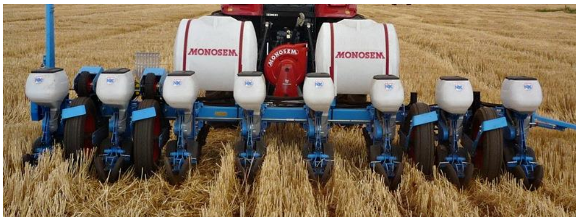
Slika 1. Širokoredna sejilica za direktnu setvu semenskog materijala
