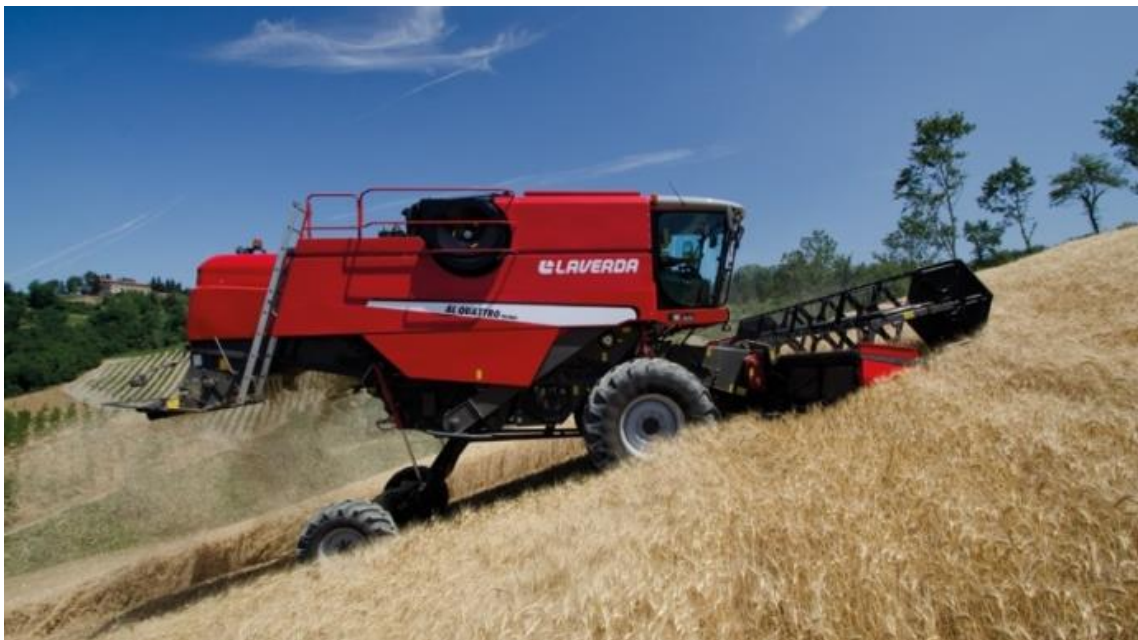
Slika 12. Kombajn namenjen terenima pod nagibom
