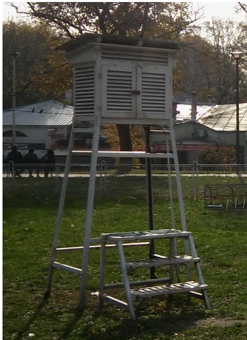
Meteorološki zaklon u kome se nalaze instrumenti za merenje temperature i relativne vlažnosti vazduha
