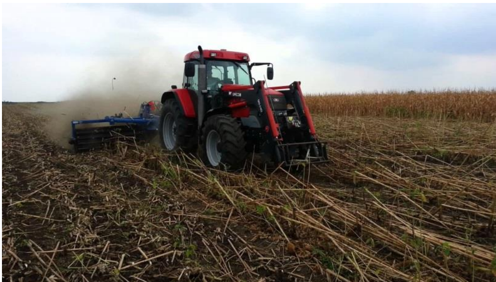
Slika 11. Usitnjavanje biljnih ostataka uljane repice sa nazubljenim valjkom
