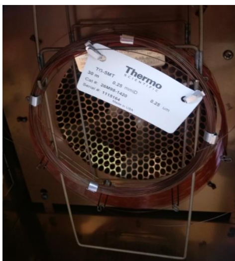
Slika 3. Kapilarna kolona Thermo Scientific™ TraceGOLD™ TG-5MT
