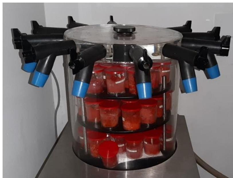
**Slika 11.** Liofilizacija plodova paprike pomoću liofilizatora (Christ ALPHA 2-4 LD plus)
