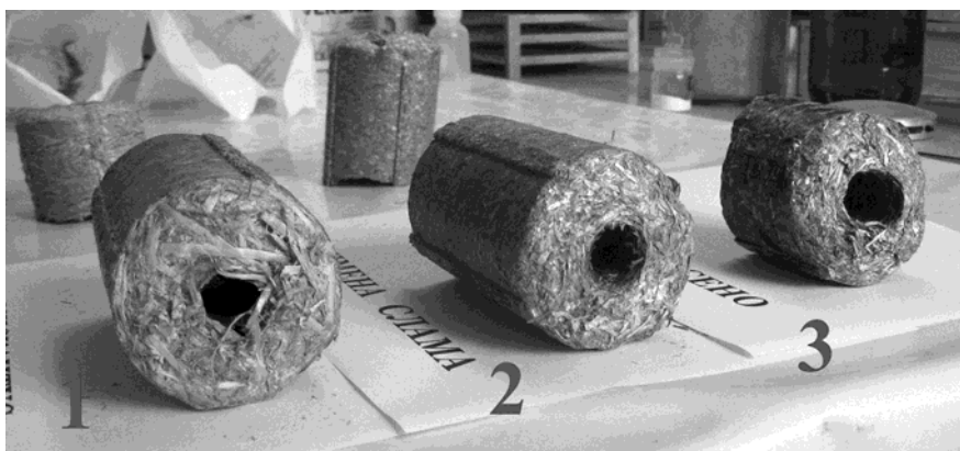
Slika 2. Briketi od slame: 1) miskantusa, 2) ječma i 3) livadskog sena Figure 2. Briquettes from straw: 1) Miscanthus, 2) barley and 3) meadow hay
